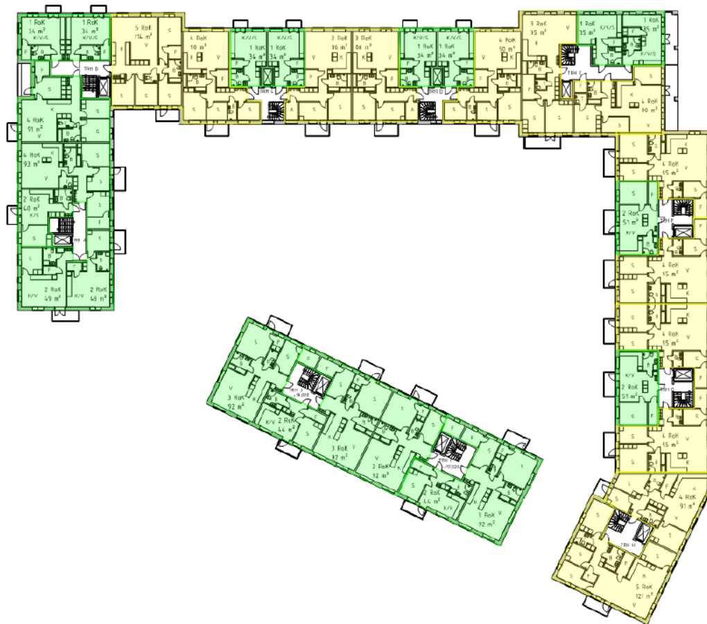
Figur 28. Plan 4, normalplan. Samtliga lägenheter klarar Förordning (2015:216) om trafikbuller vid bostadsbyggnaders riktvärden, antingen genom att minst hälften av bostadsrummen är orienterade mot en ljuddämpad sida (gulmarkerade lägenheter), eller genom att högst 60/65 dBA dygnsekvivalent ljudnivå beräknas (grönmarkerade lägenheter). Principen är samma på resterande våningsplan. (Structor, 2026-01-30a)
