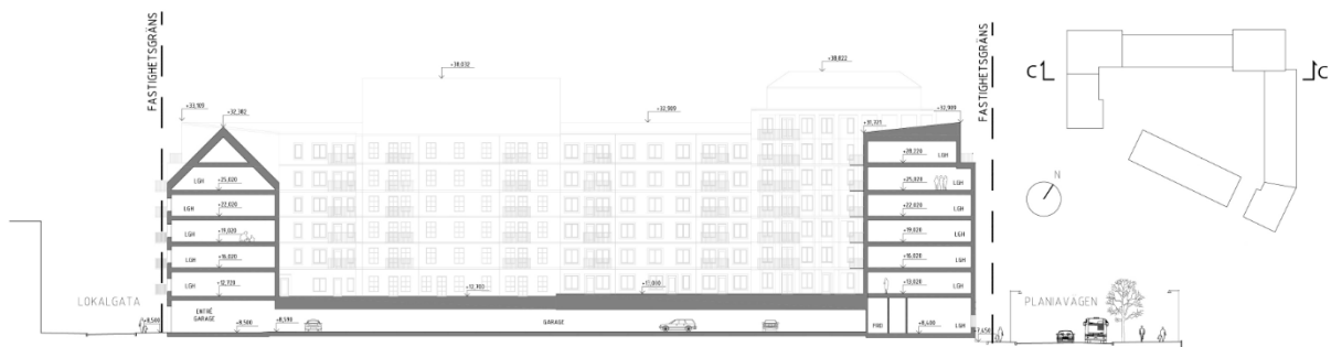
Figur 7. Sektion C-C från väster till öster. Befintlig idrottshall och ny lokalgata till vänster i bild. Planiavägen till höger i bild. (Nyréns Arkitektkontor/Bonava, 2026)
