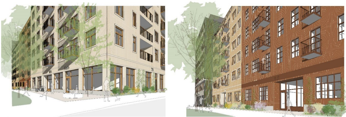
Figur 17. Exempel på utformning av entréväning med livförskjutning, en variation av liggande och stående tegelförband, uppglasade partier och grön förgårdsmark med klätterväxter. (Nyréns Arkitektkontor/Bonava, 2026)
